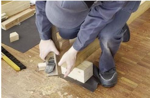
図6 桁の木口擦りの様子
